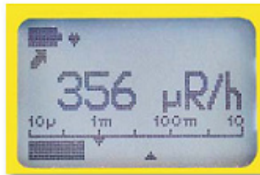
線源に接近 上向きの矢印が表示され、放射線レベルの増加を表します。
