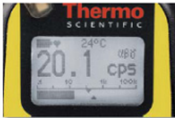
\alpha ・ \beta ・ \gamma 線の同時測定
