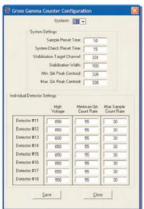
サンプルスクリーニングソフトを使うとシステムの信頼性を管理し、簡単な操作で測定を行えます。セットアップはとても簡単です。 簡単なパラメータの入力で 8 個の検出器バイアス、スタビラリザとスレッシュホールドリミットと共通の測定プリセット時間を入力します。
