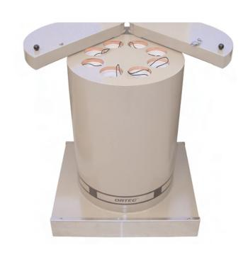
8 チャネル・ガンマ線放出試料 高速スクリーニング分析装置
