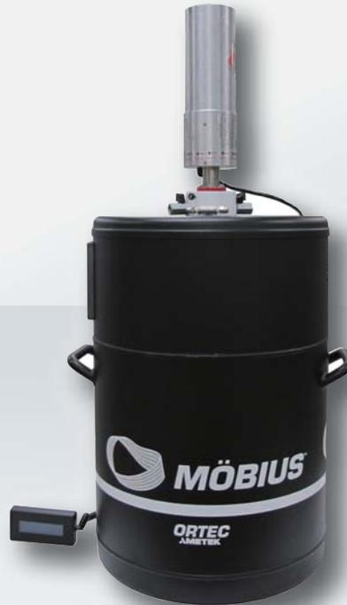
MOBIUS Recyclerは、デュワ内の液体窒素でGe検出器を冷却するとともに、デュワ内で蒸発した気体状の窒素を冷却し液体窒素に戻すことにより、液体窒素の補給頻度を大きく削減することができる装置です。Geスペクトロメトリシステムへの定期的な補給作業低減やコスト削減に優れた効果を発揮します。
